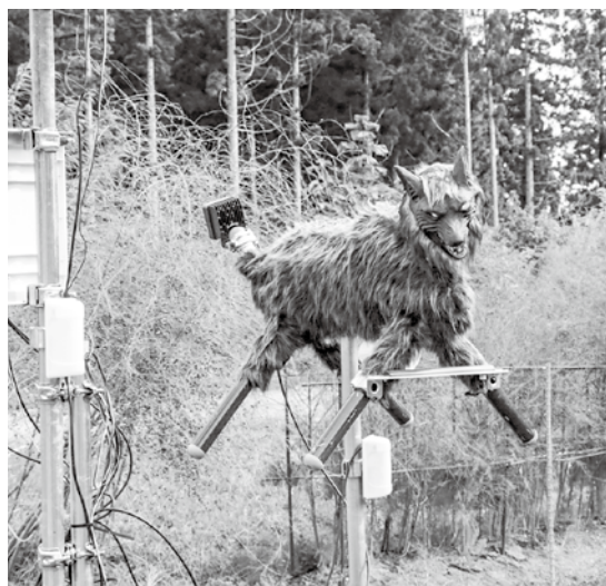
瀬辺地地区に試験的に置かれたスーパーモンスターウルフ。センサーで動物を検知するとオオカミ咆哮で威嚇音声を発する。首を左右に振り、目は赤く発光する。
