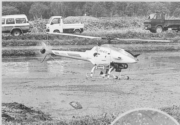
使用されたラジコンヘリ。 作業は1枚の田(3反歩)につき、 10分ほどで完了します。
