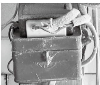
参考写真として提出された 米の乾燥機の低圧コンデンサー
