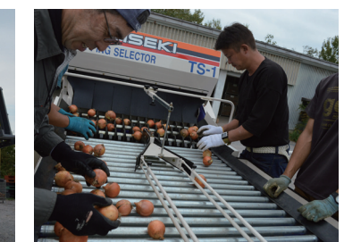
▲一度に大量の玉ねぎを処理できます ▲機械上部で選別作業を行う生産組合員
